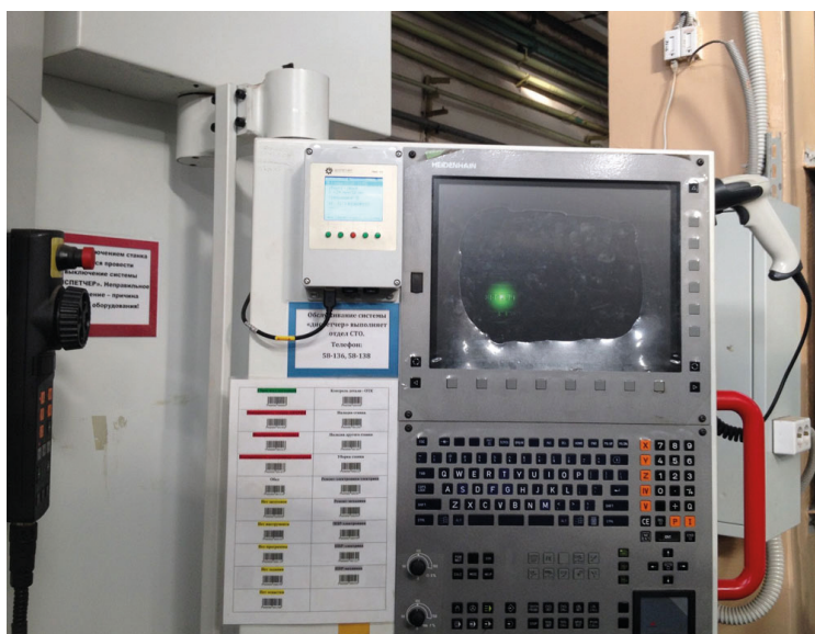
РИС. 5. СМОЛЕНСКАЯ КОМПАНИЯ "СТАНКОСЕРВИС" ПРЕДЛАГАЕТ АИС "ДИСПЕТЧЕР". НА ФОТО (С САЙТА РАЗРАБОТЧИКА) – ТЕРМИНАЛ-РЕГИСТРАТОР ТВВ10 СМОНТИРОВАН НА СТОЙКЕ ЧПУ HEIDENHAIN.
