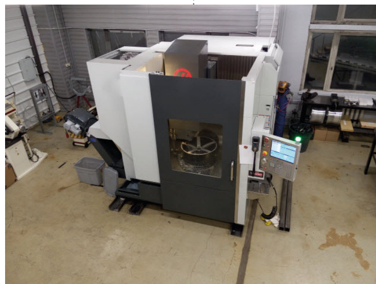
ПРОЦЕСС ОБРАБОТКИ ДИСКА НА НОВОМ HAAS UMC-750.
